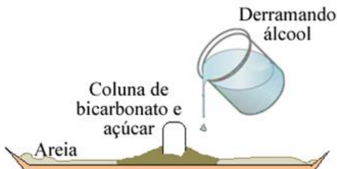
Figura 3. Sistema de combustão.
